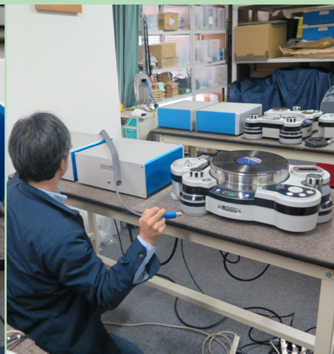
△空氣冷凝器 / 打氣電泵機箱的面板設有三隻氣浮腳的指示燈號，不夠氣會亮紅色，按照指示在唱盤前面的對應喉咀打氣，當燈號轉為藍色便表示有足夠氣壓，方便快捷。
