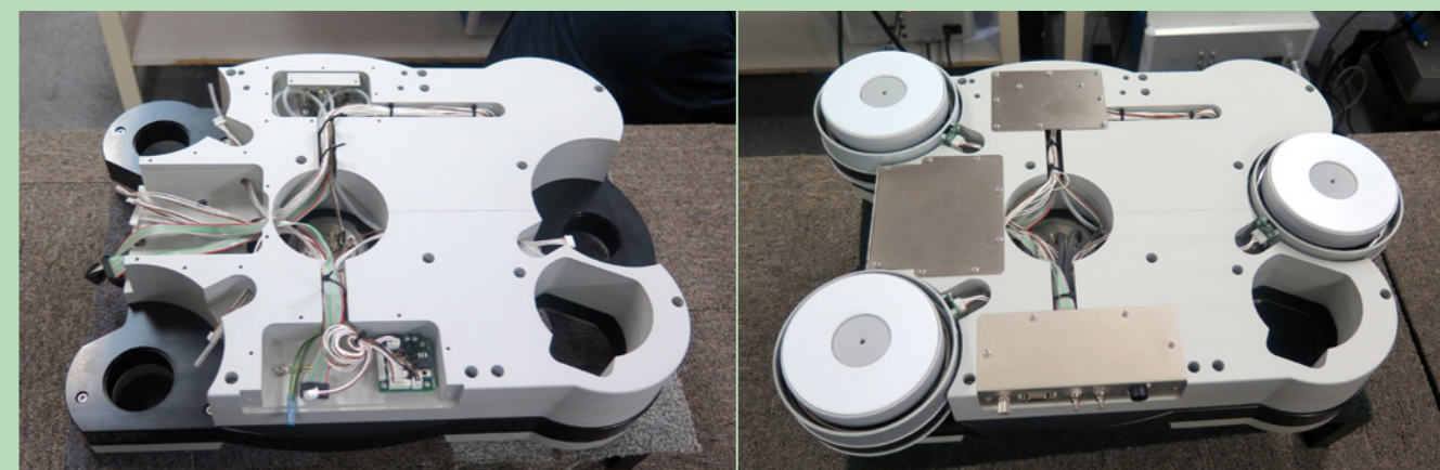
△翻轉唱盤底部安裝機腳與接線。
