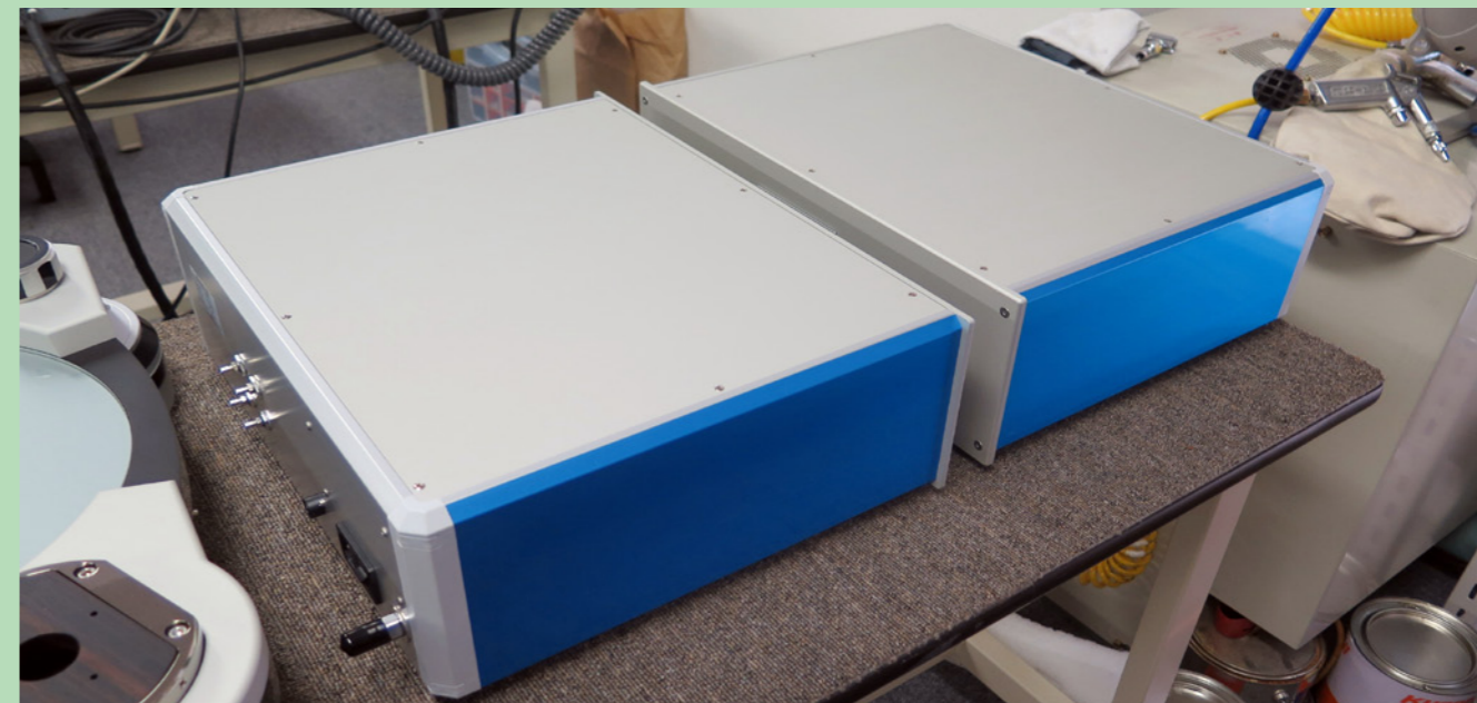
△這兩個機箱分別是電源供應 / 氣泵和空氣冷凝器 / 打氣電泵的所在。它們雖然負責這台唱盤的氣浮驅動和真空吸索功能，但工作時卻是靜如深海，粒聲都冇，所以擺放在唱盤附近也不會有任何影響。
