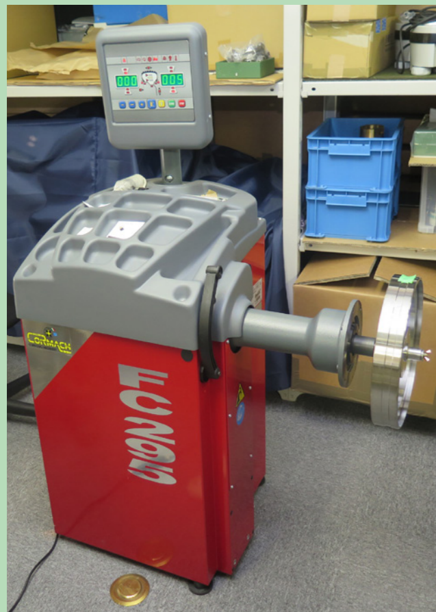
△這台機器本來是用作戰輪胎的，TechDAS 工程師改裝之後，便可以用來測試轉盤的圓心是否有任何輕微偏差。
