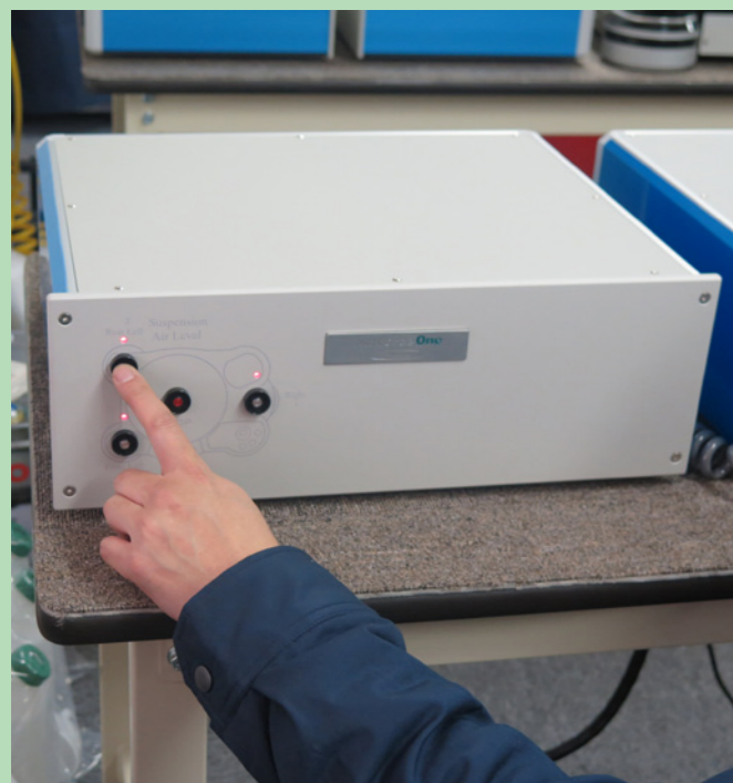
△空氣冷凝器 / 打氣電泵機箱的面板設有三隻氣浮腳的指示燈號，不夠氣會亮紅色，按照指示在唱盤前面的對應喉咀打氣，當燈號轉為藍色便表示有足夠氣壓，方便快捷。
