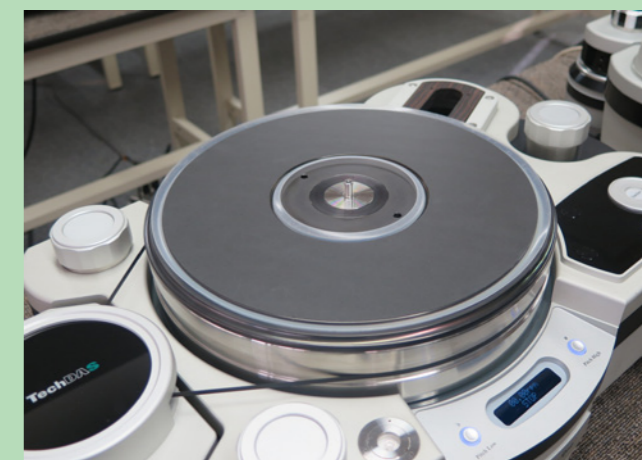
△ TechDAS 也生產了一塊只是作為實驗用途，採用鎢來製造的副轉盤，重 20kg。西川先生表示雖然音效明顯比純鈦副轉盤更為超班，但製作成本非常昂貴，要賣 450 萬日元一塊，應該無人問津的了。
