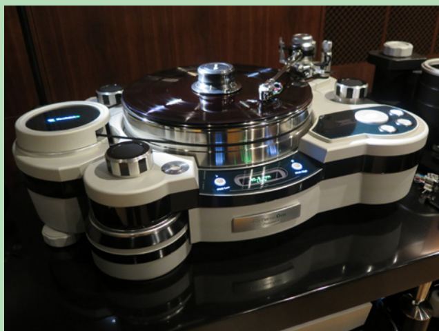
△靚聲的主要功臣——配上鎢唱片壓，純鈦臂管的 Graham Phantom Elite 唱臂和 TechDAS 鈦殼 TDC01 Ti 唱頭的 Air Force One Premium 唱盤。
