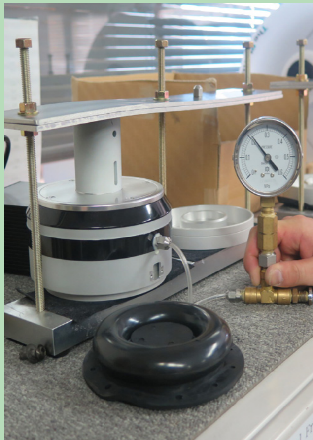
△這個用特殊橡膠製造的氣囊便是氣浮隔震機腳內的主要元件，每一隻腳都要經過連續多天壓力測試，證明沒有漏氣才可以使用。
